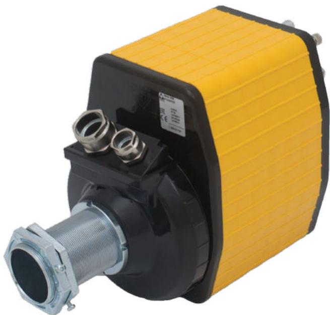
Collettore rotante costituito da anelli accoppiati a spazzole, studiato per consentire il passaggio di corrente elettrica da una parte fissa ad una in rotazione e utilizzato per l'alimentazione dei motori di gru e macchine avvolgicavo.
