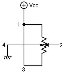
**Esempio di collegamento 1 - Wiring example 1**
