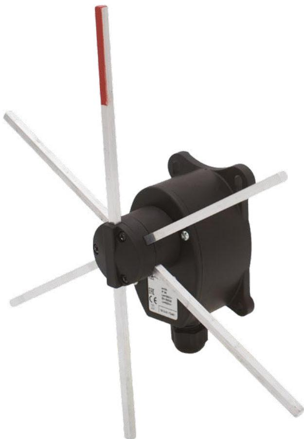
Finecorsa di posizione progettato per il controllo del movimento di carriponte, paranchi e macchine operatrici industriali complesse. Tango ha aste con movimento a posizioni mantenute ogni 60°.
